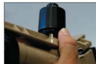
Secillo ajuste de la tensión del muelle de torsión.
